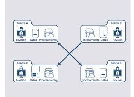
Escenario 1: conectividad sin CellaVision Server Software En una instalación CellaVision estándar, la base de datos del flujo de trabajo reside localmente en las PC conectadas a los analizadores. Se puede obtener acceso a las bases de datos individuales de forma remota, pero no es posible consolidar listas de trabajo.
