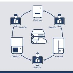
Escenario 2: conectividad con CellaVision Server Software En una instalación con CellaVision Server Software, la base de datos del flujo de trabajo reside en un solo servidor compartido. Todos los usuarios obtienen fácil acceso y los portaobjetos procesados dentro de la red pueden revisarse con el método "primero en entrar, primero en salir".
