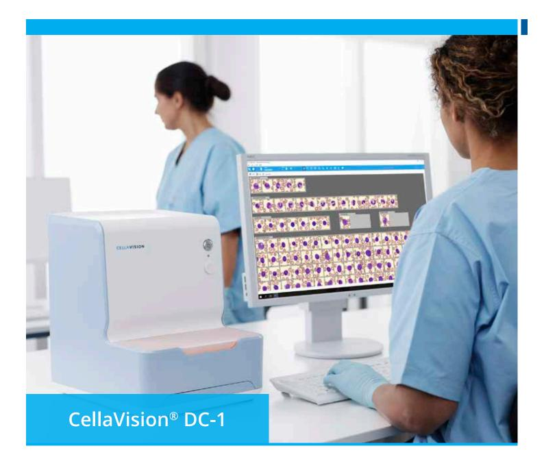
El modelo CellaVision DC-1 está diseñado para automatizar y simplificar el proceso de realización de diferenciales de células sanguíneas en laboratorios de bajo volumen. El sistema se beneficia de los procesos de robótica e imagen digital de alta velocidad para ubicar y capturar imágenes de alta calidad de las células de forma automática. Permite la instalación tanto **independiente** como **en red**.
